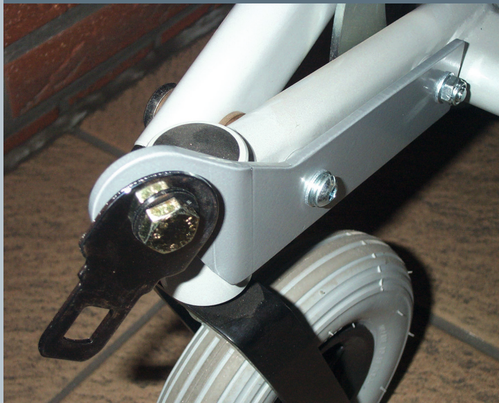
Zwei vordere Kraftknotensysteme mit jeweils einer Schwerlastöse für Spannretractor oder Statikgurt.
