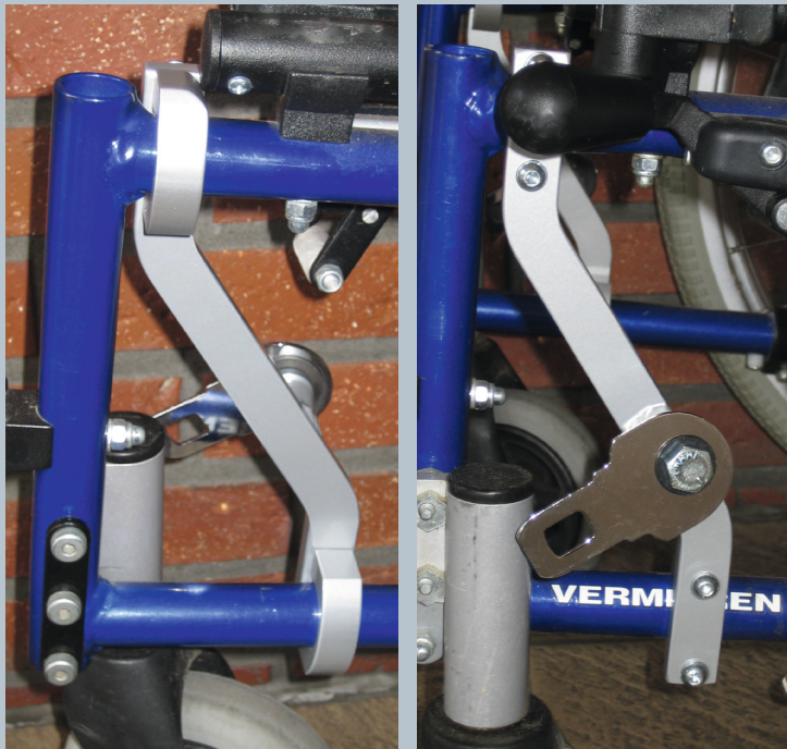
Zwei vordere Kraftknotensysteme mit jeweils einer Schwerlastöse für Spannretractor oder Statikgurt.
