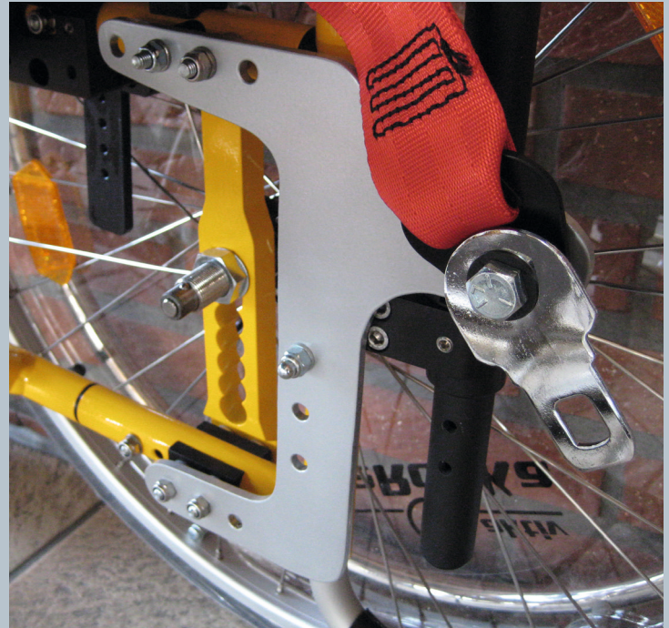
Zwei hintere Kraftknotensysteme mit jeweils einer genormten Schwerlastöse für Spannretractor. Der Beckengurt ist bereits fest montiert.
