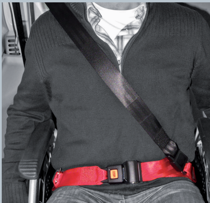
Der Beckengurt (rot) ist fester Bestandteil des Kraftknotens. Der Schulterschräggurt (schwarz) ist im KMP/Kfz montiert.
