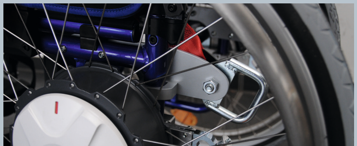
Zwei hintere Kraftknotensysteme mit jeweils einer genormten Schwerlastöse für Spannretractor. Der Beckengurt ist bereits fest montiert.
