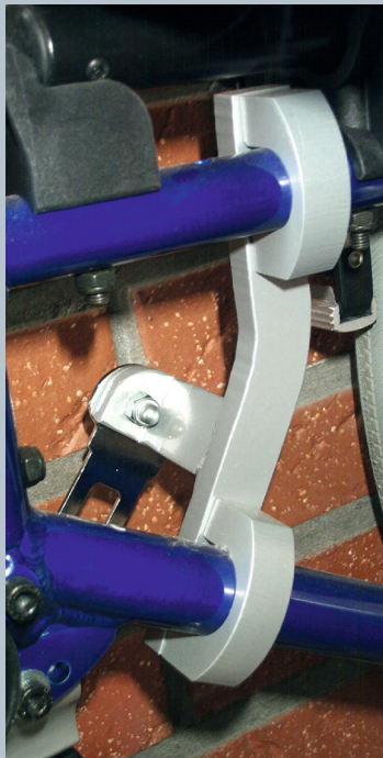
Zwei vordere Kraftknotensysteme mit jeweils einer Schwerlastöse für Spannretractor oder Statikgurt.
