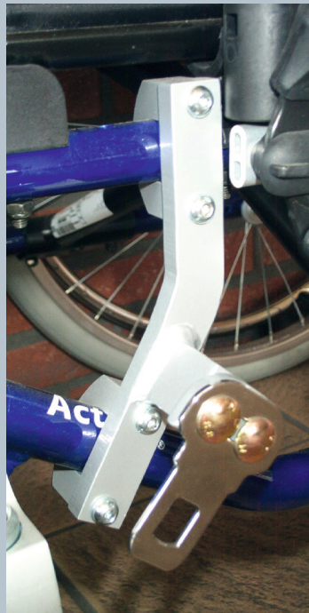
Zwei vordere Kraftknotensysteme mit jeweils einer Schwerlastöse für Spannretractor oder Statikgurt.
