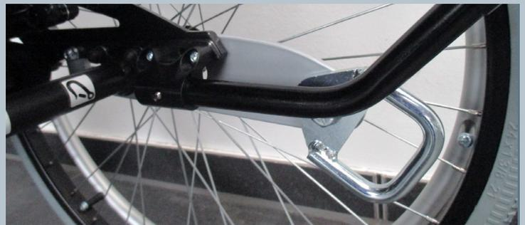
**Zwei vordere Kraftknotensysteme** mit jeweils einer genormten Schloßzunge bzw. Schwerlastöse für Spannretraktor oder Statigurt.
