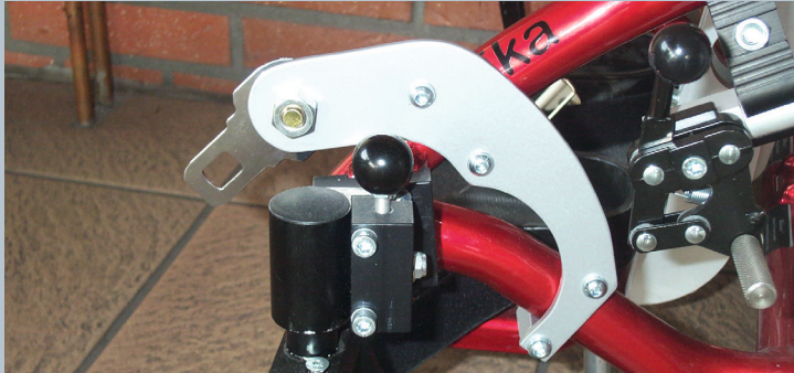
Zwei vordere Kraftknotensysteme mit jeweils einer Schwerlastöse für Spannretractor oder Statikgurt.
