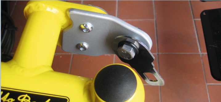
Zwei vordere Kraftknotensysteme mit jeweils einer Schwerlastöse für Spannretractor oder Statigurt.
