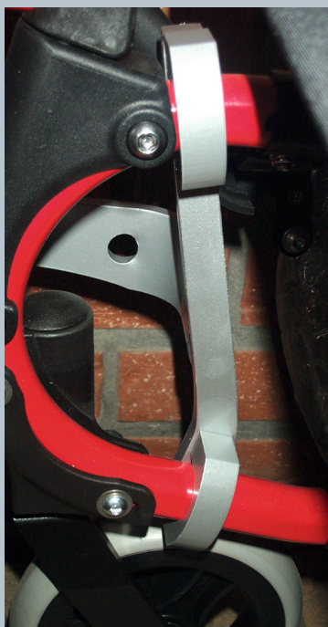
Zwei vordere Kraftknotensysteme mit jeweils einer Schwerlastöse für Spannretractor oder Statikgurt.
