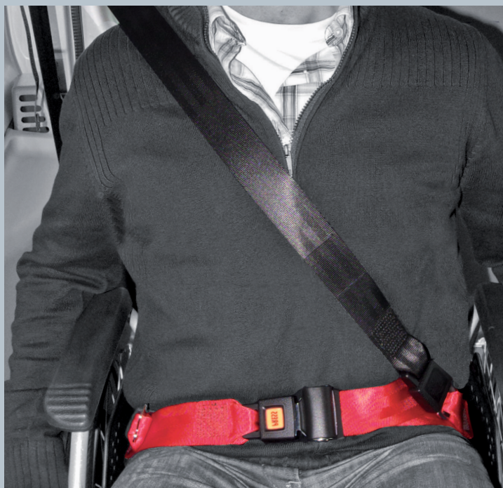
Der Beckengurt (rot) ist fester Bestandteil des Kraftknotens. Der Schulterstraggurt (schwarz) ist im KMP/Kfz montiert.
