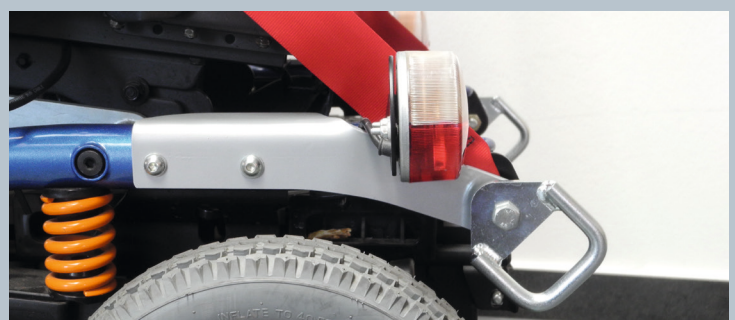
Zwei hintere Kraftknotensysteme mit jeweils einer genormten Schwerlastöse für Spannretractor. Der Beckengurt ist bereits fest montiert.
