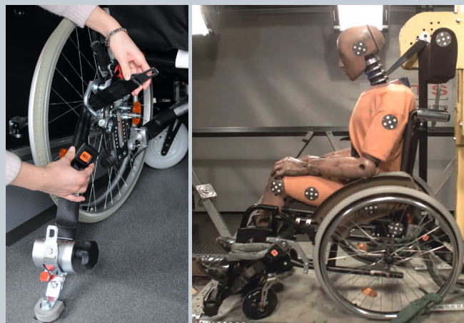
Eindeutige, geprüfte Anbindungspunkte zur sicheren Befestigung
