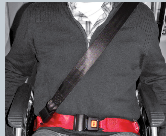
Der integrierte Beckengurt (rot) ist fester Bestandteil des AMF-Bruns Kraftknotensystems
