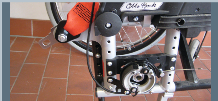
Zwei hintere Kraftknotensysteme mit jeweils einer genormten Schwerlastöse für Spannretractor. Der Beckengurt ist bereits fest montiert.
