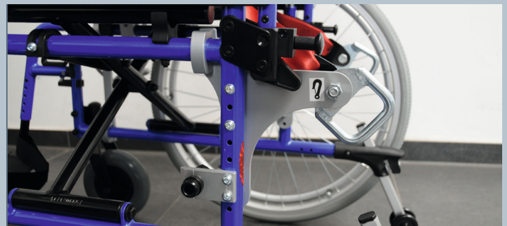
Zwei hintere Kraftknotensysteme mit jeweils einer genormten Schwerlastöse für Spannretractor. Der Beckengurt ist bereits fest montiert.
