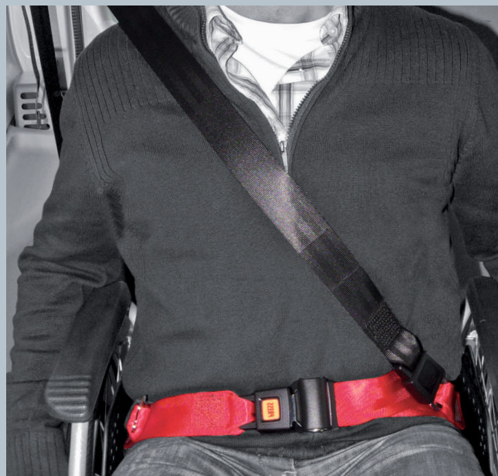
Der Beckengurt (rot) ist fester Bestandteil des Kraftknotens. Der Schultersträggurt (schwarz) ist im KMP/Kfz montiert.
