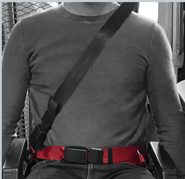
Der Beckengurt (rot) ist fester Bestandteil des Kraftknoten. Der Schulterstraggurt (schwarz) ist im KMP/Kfz montiert.
