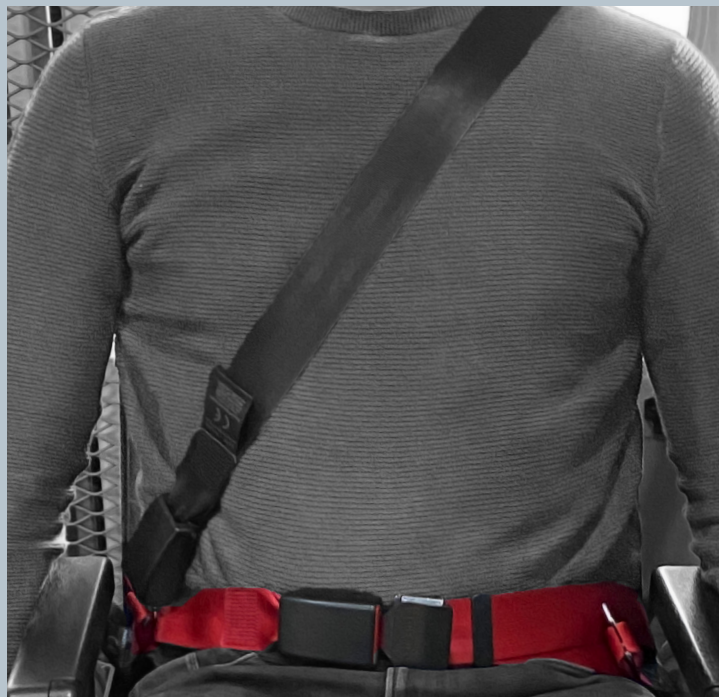
Der Beckengurt (rot) ist fester Bestandteil des Kraftknotensystems. Der Schulterstraggurt (schwarz) ist im KMP/Kfz montiert.
