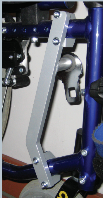
Zwei vordere Kraftknotensysteme mit jeweils einer Schwerlastöse für Spannretraktor oder Statikgurt.
