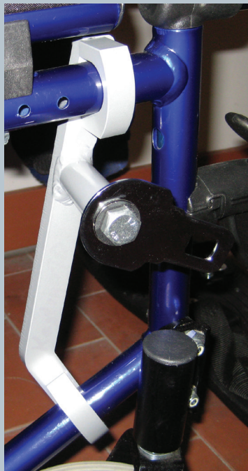
Zwei vordere Kraftknotensysteme mit jeweils einer Schwerlastöse für Spannretraktor oder Statikgurt.
