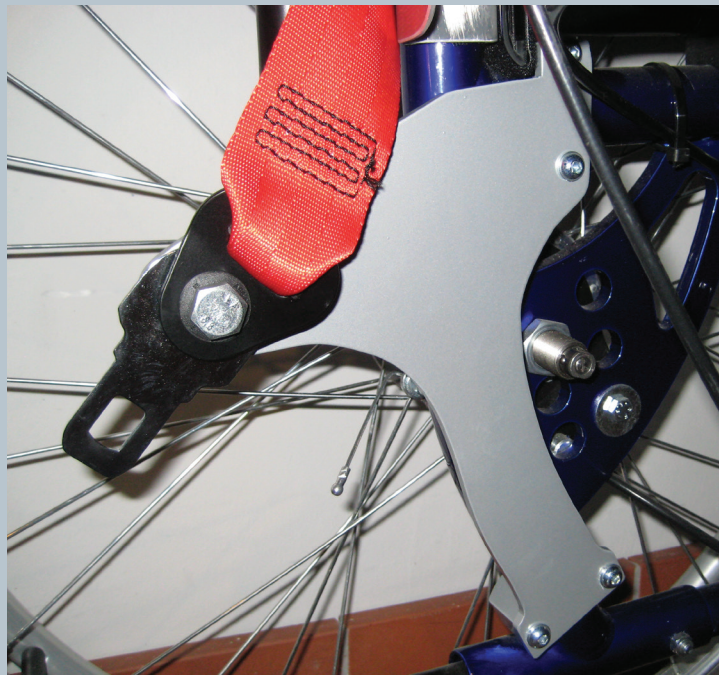
Zwei hintere Kraftknotensysteme mit jeweils einer genormten Schwerlastöse für Spannretraktor. Der Beckengurt ist bereits fest montiert.
