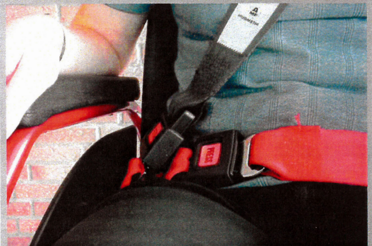
Beckenhaltegurt (rot) fest an Kraftknoten montiert, Schulterschräggurt (schwarz) in BTW montiert
