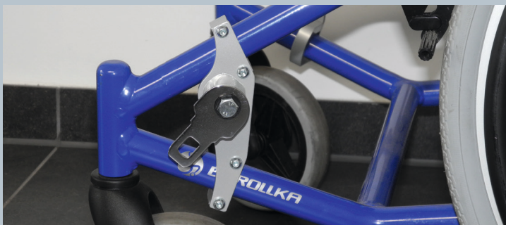
Zwei vordere Kraftknotensysteme mit jeweils einer Schwerlastöse für Spannretractor oder Statigurt.
