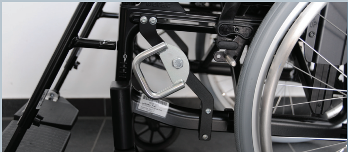
Zwei vordere Kraftknotensysteme mit jeweils einer Schwerlastöse für Spannretraktor oder Statikgurt.
