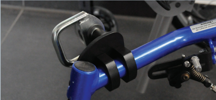
Zwei vordere Kraftknotensysteme mit jeweils einer Schwerlastöse für Spannretraktor oder Statikgurt.
