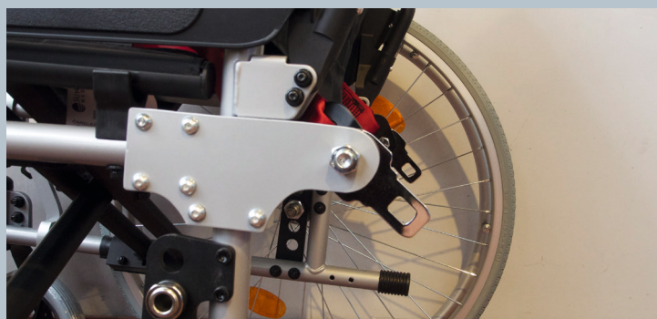
Zwei hintere Kraftknotensysteme mit jeweils einer genormten Schwerlastöse für Spannretractor. Der Beckengurt ist bereits fest montiert.
