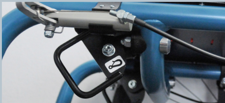
Zwei vordere Kraftknotensysteme mit jeweils einer Leichtbauöse für Spannretractor oder Statigurt.
