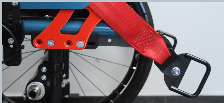
Zwei hintere Kraftknotensysteme mit jeweils einer Leichtbauöse für Spannretractor. Der Beckengurt ist bereits fest montiert.
