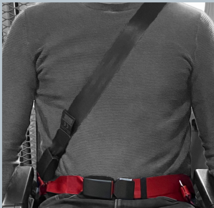
Der Beckengurt (rot) ist fester Bestandteil des Kraftknotensystems. Der Schulterschräggurt (schwarz) ist im KMP/Kfz montiert.
